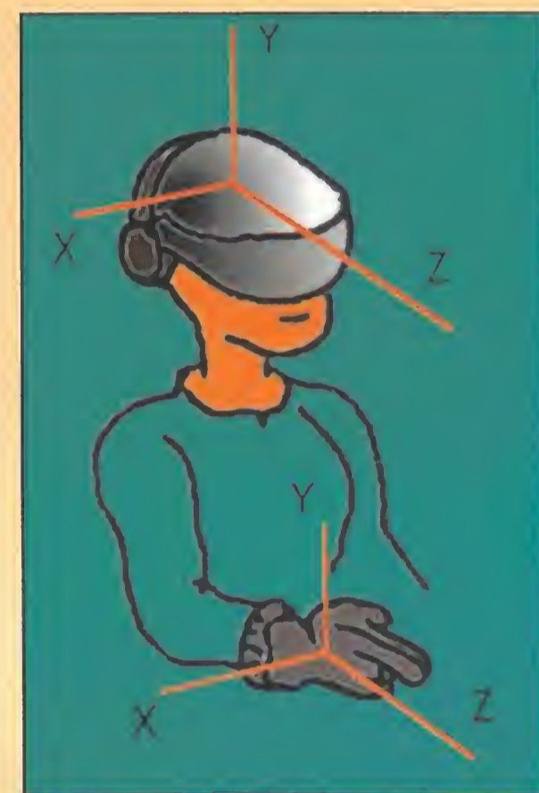
Posición del casco en un eje de coordenadas 3D. Posición de la mano, provista de un DataGlove, en el espacio 3D.
